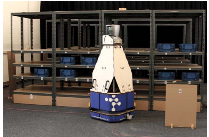
FTS mit Sensorturm bei der Innenraumvermessung im FS-Logistiksimulator
