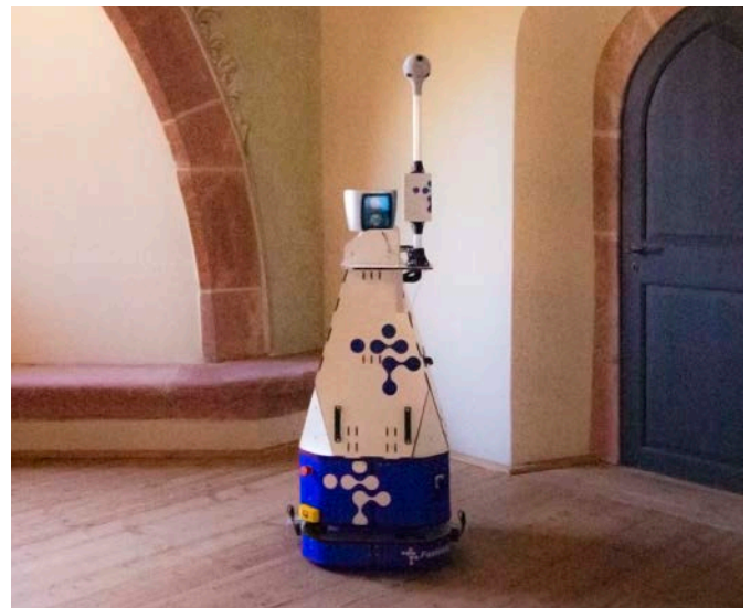
FTS mit Sensorturm bei der Innenraumvermessung auf Schloss Rochlitz
